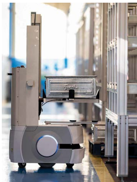
« SAMROB » fournit automatiquement les pièces sur les cellules d'usinage
